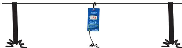
A tensão mínima aceitável deve ser superior a 2kV para bovinos e no mínimo 4kV para ovinos. Faça o teste no início e no fim da cerca. **ATENÇÃO: Não utilize chave de fenda teste** para testar o choque.
